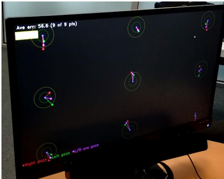
Figura 10-4. Pantalla de calibración del eye-tracker .
