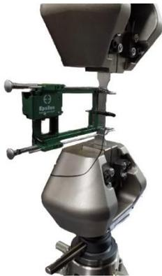
Fig. 1. Prueba de tensión de perfil 6063-T5.
