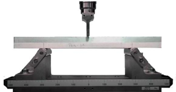
Fig. 3. Prueba de flexión de tres puntos.
