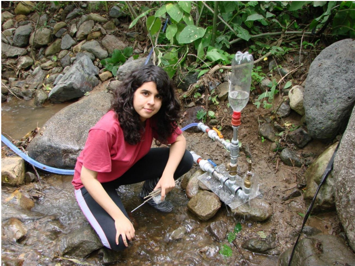
Figura 1.- Fotografía del sistema de bombeo en una de sus pruebas de funcionamiento.
