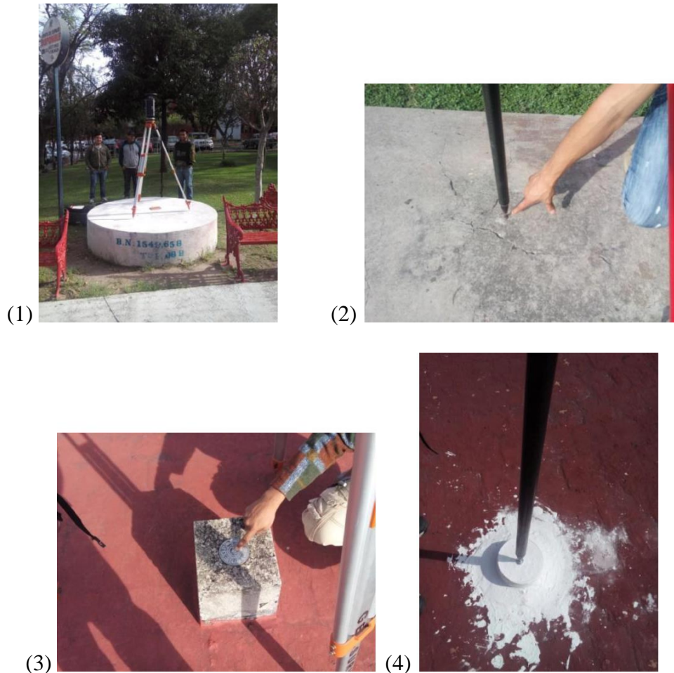
Figura 3.- Diversas escenas del operativo de medición: (1) BN01 frente a Rectoría; (2) BN02 empotrado en mojonera rectangular de concreto; (3) vértice GUA002 perteneciente a la Red Geodésica Estatal, base de la medición con la RGNA; (4) Mojonera tipo de la red geodésica CUCEI.
