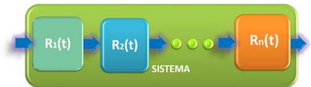
Figura 3. Confiabilidad de un sistema en serie, del primero hasta el n-ésimo componente.
