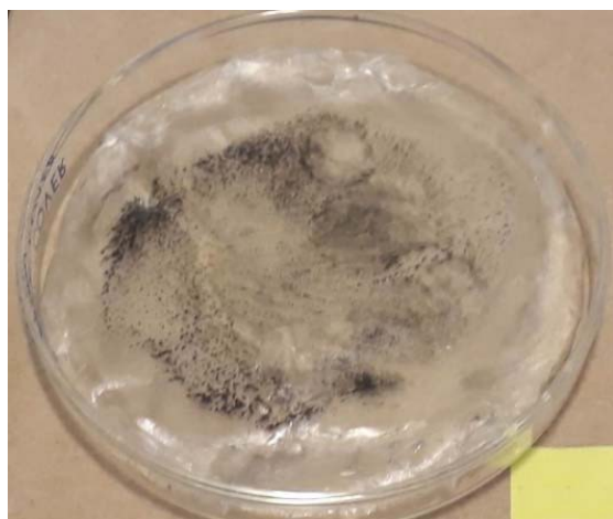
Figura 1. Membrana de PS/MWNTs. Diámetro y espesor: 8 cm y 1.1 mm, respectivamente.
