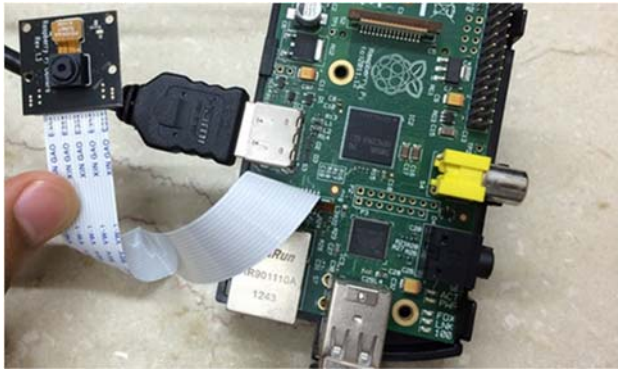
Figura 2. Minicomputadora y cámaras utilizadas en la automatización y control del sistema de vigilancia y monitoreo.
