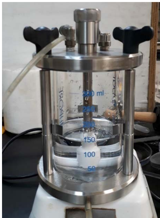
Figura 2. Celda de prueba de filtrabilidad de la membrana PS/MWNTs.
