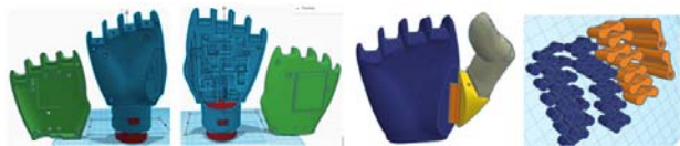
Figura 6. Diseño modificado de la palma, dedo pulgar y falanges realizadas en Tinkercad.
