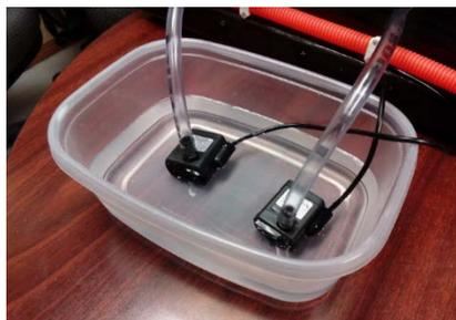
Figura 20 Bombas de riego.
