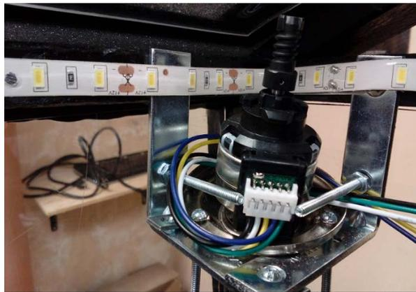
Figura 23 Motor elevador para la compuerta del techo.
