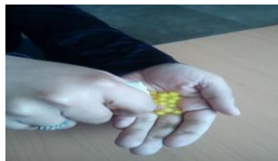
Figura 3. Hidrogel retirado del mingitorio
