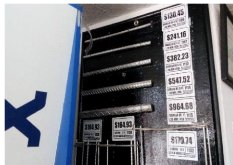
Figura 3. Acero de refuerzo de resistencia normal 4200kg/cm 2 .
