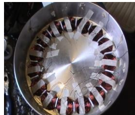
Fig. 6. Diagrama de ubicación de bobinas del estator (Fuente: Propia).
