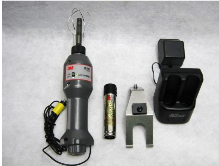
Figura 18. Anemómetro omnidireccional modelo Quest AIR PROVE. Fuente: https://www.soriaudio.com/files/attach/images/207/361/981/023/fb8e6e7f8945c054582435d65c2fed90.jpg
