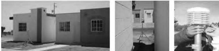
FIGURA 6. Equipo de monitoreo exterior: sensor de temperatura y humedad relativa.
