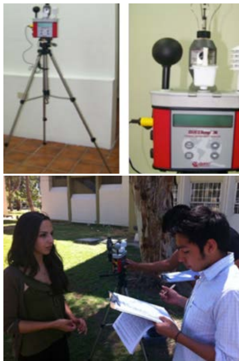
Figura 3. Monitor de estrés térmico y aplicación de encuestas Fuente: (Tomada por los autores)
