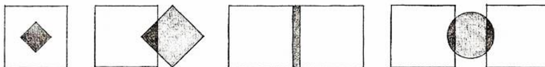
Figura 2.1: Tipos de relaciones espaciales: Espacio dentro de otro, espacios conexos, espacios contiguos, espacios vinculados por otro espacio. Fuente: Ching (2000).
