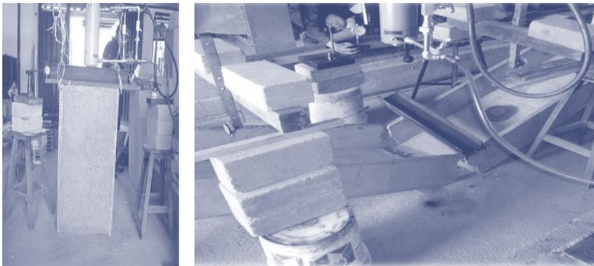
Figura 2. Caracterización mecánica de sistemas muro y techo.
