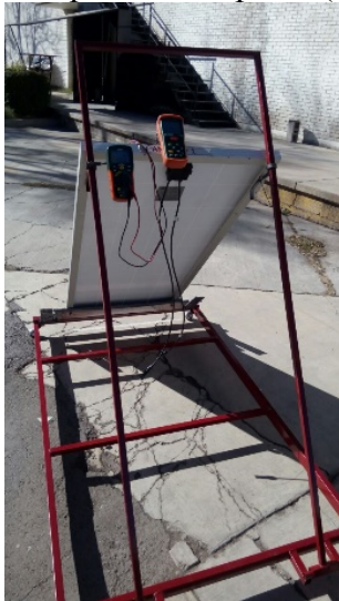
Figura 2.3 Sistema de medición de un panel solar a 40° de inclinación. Fuente: Propia.
