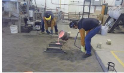
Fig. 4. Vaciado del metal en los moldes.
