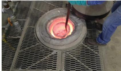
**Fig.2** Fusión del material en el horno de piso
