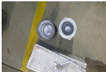
Fig. 9. Muestra de los residuo en los crisoles del equipo PODFA
