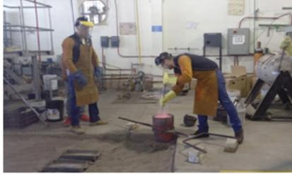
Fig. 3 Separación de la Escoria del metal.
