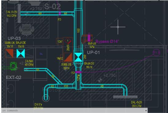
Figura 3. Trayectoria preliminar de la UP-03 con líneas color azul y la ubicación de rejillas para la planta baja de las oficinas del hangar.
