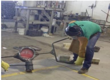
Fig. 6. Vaciado del metal en el crisol del equipo PODFA para la realización de la prueba.
