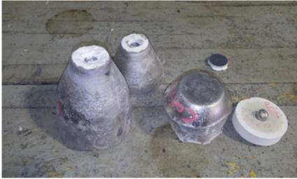
Fig. 10. Muestra de los residuos en los crisoles del equipo PODFA.
