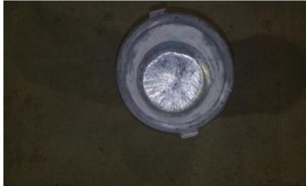
Fig. 11. Muestra de los residuos en los crisoles del equipo PODFA
