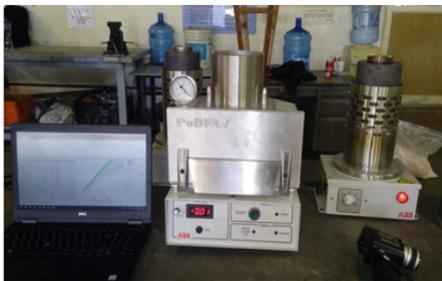
Fig. 8. Análisis y registro de datos en Equipo PODFA
