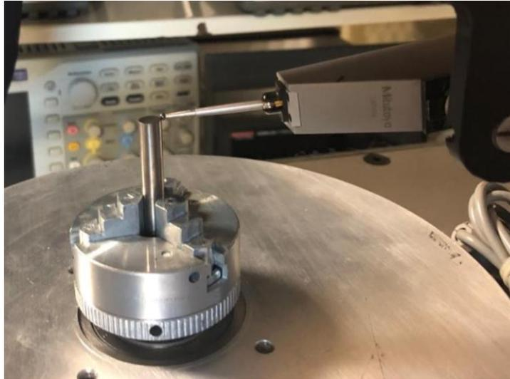
*Figura 47. Centrado de pieza con palpador.*
