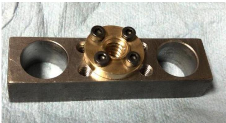
*Figura 25. Sistema de fijación de barras Thompson.*
