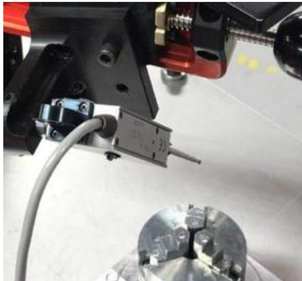
*Figura 41. Palpador alineado con chuck.*
