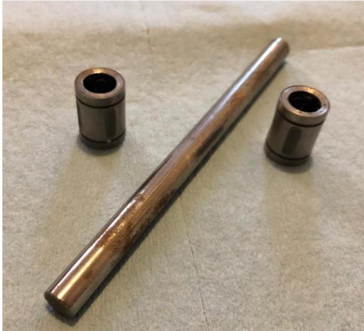
*Figura 26. Barra estriada y oxidada con baleros rotos.*
