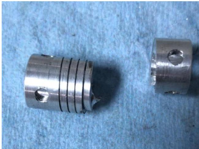
*Figura 38. Cople de seguridad quebrado.*
