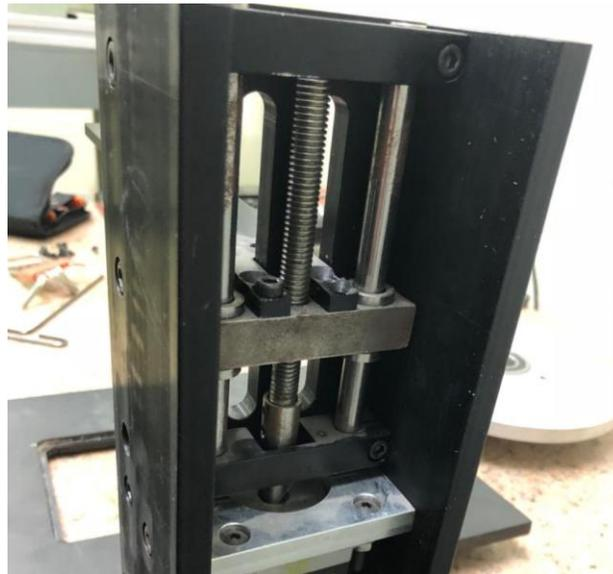
*Figura 19. Sistema de desplazamiento en el eje “Z”.*
