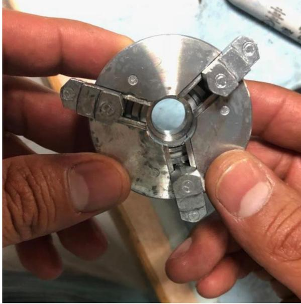
*Figura 40. Chuck abierto a su máxima capacidad.*
