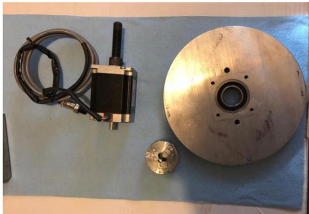
*Figura 27. Componentes del sistema de rotación.*
