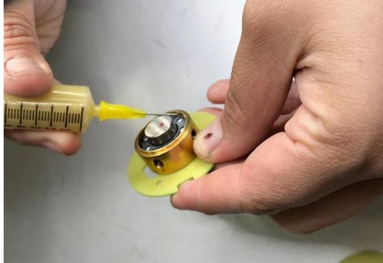
Figura 4.13 Aplicación de adhesivo
