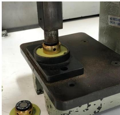
Figura 4.12 Prensado de resistencia en frame
