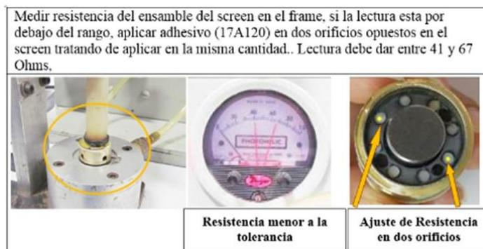
Figura 4.8 Proceso de ajuste y prueba de resistencia
