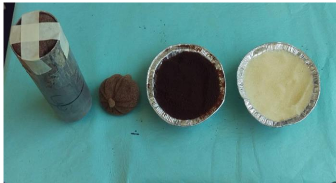
Figura 2. De izquierda a derecha se muestran el cilindro de aluminio con la bolsa resina sujeta con cinta adhesiva; bolsa de nylon con mezcla de resinas; la resina catiónica color café, y la resina aniónica color amarillo.
