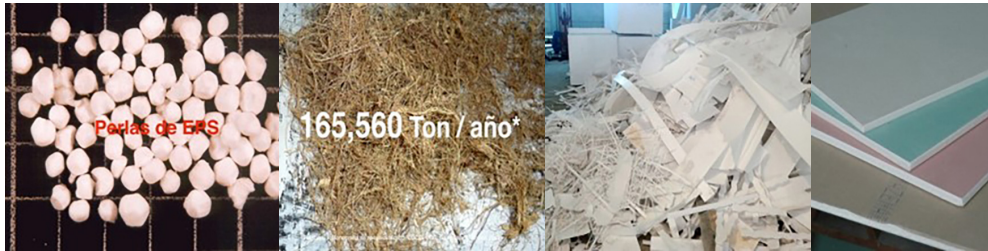
FIGURA 2. Material reciclado para la elaboración de la placa “EPSA 123”, poliestireno expandido, fibra de agave y yeso.
