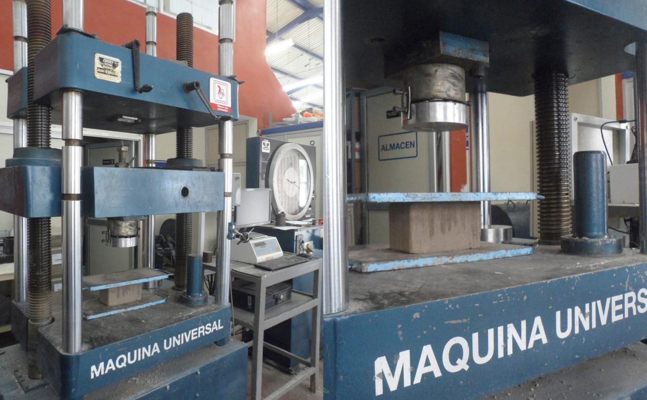
**FIGURA 5.3.** Prensa universal para realizar pruebas de resistencia a la compresión.
