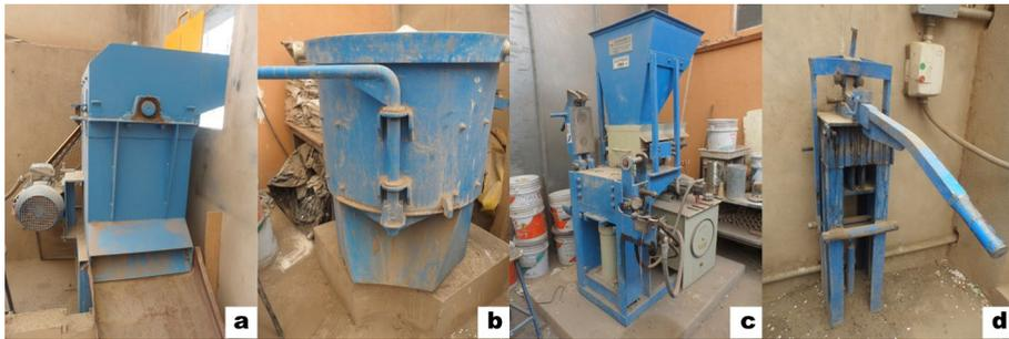
**FIGURA 5.2.** a: Trituradora de molinos; b: Mezcladora tipo turbina; c: Prensa hidráulica Adopress 1000; d: Adobera manual.
