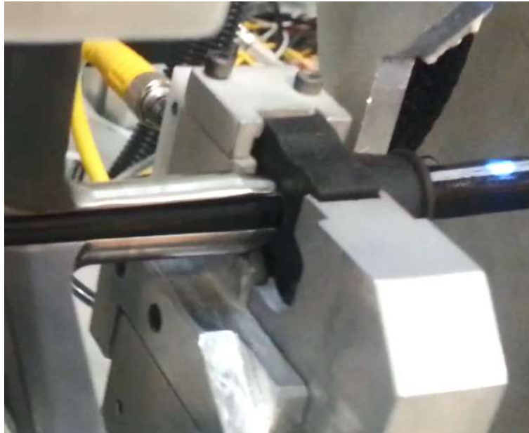
Figura 4.17 Grommet en posición correcta con expulsores fuera
