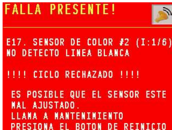
Figura 4.16 Indicación de falla en encontrar la línea blanca
