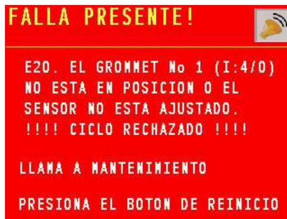
Figura 4.19 Indicación de falla de grommet removido
