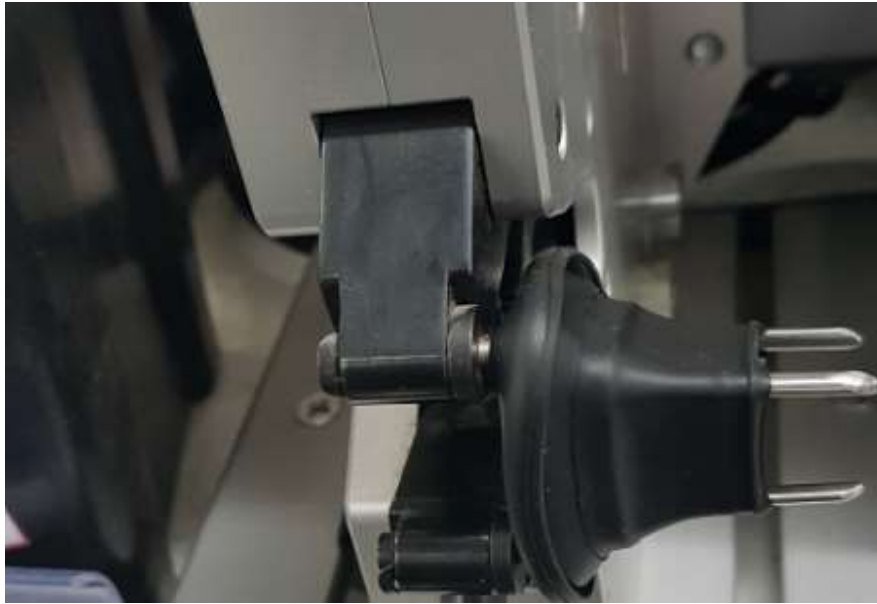
Figura 4.13 Expulsores dentro del grommet y abiertos
