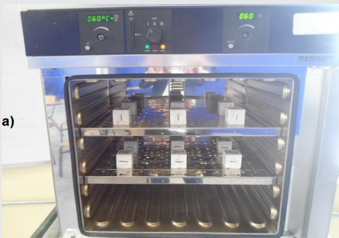
Figura 6. a) Probetas dentro del horno de secado
