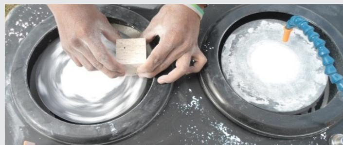
Figura 4. Lijado y pulido de las probetas.
