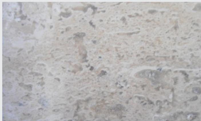
Figura 2. Superficie del travertino tipo Puebla
