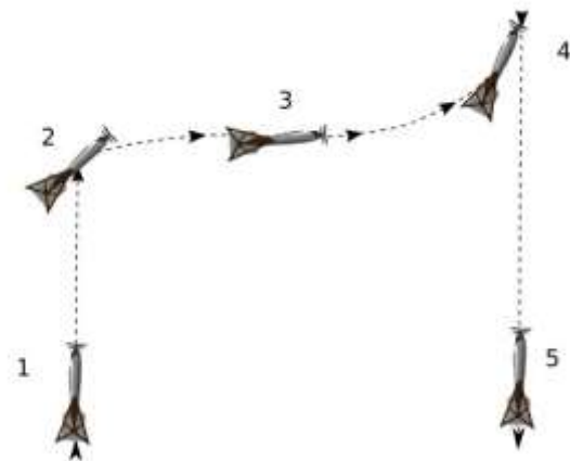
Figura 1. Operación de aeronave VTOL [1]. Se realizaron diversas simulaciones con diferentes ángulos de ataque, esto con el fin de poder simular las diferentes etapas de vuelo.
