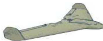
Figura 1. Se muestra una de las configuraciones posibles para el diseño del VANT de ala fija.
