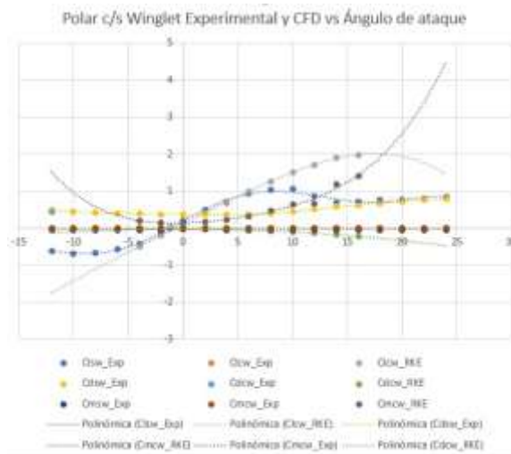
Figura 1. Polar c/s winglet de datos experimentales y numéricos CFD vs. ángulo de Ataque.
