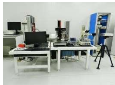
Fig. 1. Sistema patrón para la medición del número de Dureza en el CENAM.
