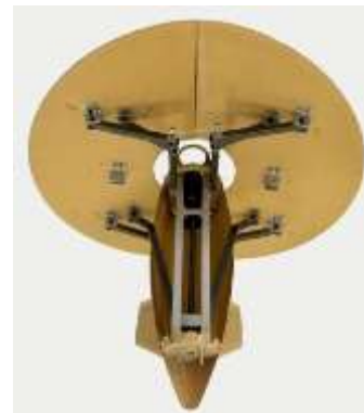
Figura 1. Cápsula en posición de desaceleración máxima.
