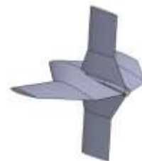
Figura 4. Nueva configuración con flechado invertido en la punta de ala.
