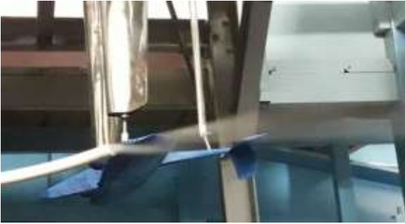
Figura 1. Interacción de líneas de humo sobre la punta de la semi-ala.
