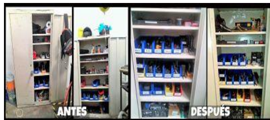
Figura 10. Estante de herramientas del área de tornos antes y después de las 3 primeras “S” clasificación, organización, limpieza y fábrica visual.
