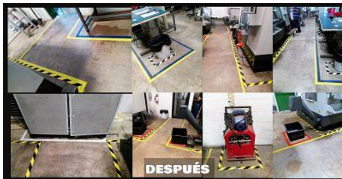
Figura 9. Delimitación del área de producción aplicando la seguridad industrial después de la asignación de colores adecuados.
