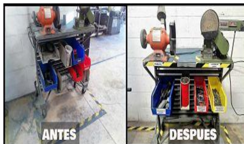
Figura 8. Mesa de esmeril y lijadora de banda del área de producción antes y después de las 3 primeras “S” clasificación, organización, limpieza + seguridad y fábrica visual.
