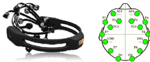
Fig. 2. Plataforma EPOC Emotiv (izquierda) y distribución de los electrodos (derecha).
