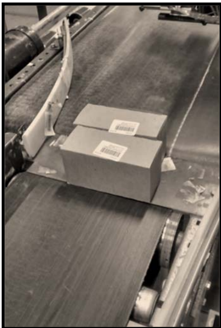
Fig. 11. Gap de acrílico que está entre la banda y otro.
