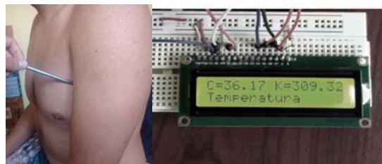
Figura 23. Datos de temperatura mostrados en LCD
