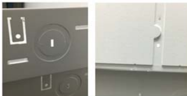
Fig. 4. Impurezas en la pintura debido a la contaminación de la banda transportadora
