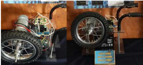
Figura 16. Prototipo del sistema embebido para la asistencia motriz
