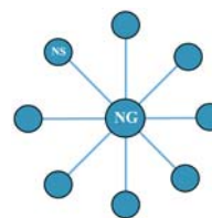
Fig. 1. Red con topología estrella compuesta por un nodo gateway en el centro y n nodos sensores.
