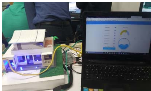
Figura 2: Sensores de temperatura, control y visualización desde la red de internet.
