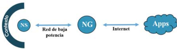
Fig. 2. Diagrama de comunicación entre el nodo sensor, nodo gateway y aplicaciones en la nube.
