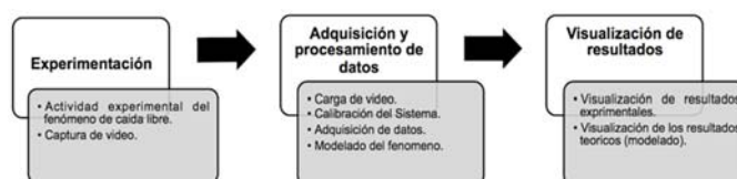
Fig. 2. Fase de aplicación del sistema de adquisición de datos
