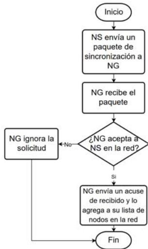
Fig. 3. Diagrama de flujo del proceso de incorporación de nuevos nodos a la red.
