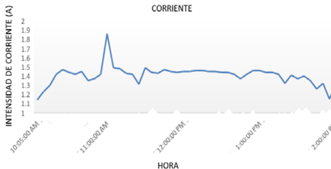
Figura 16. Corriente del panel solar.
