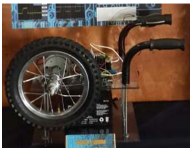
Figura 3. Prototipo, sensor de fuerza en el manillar
