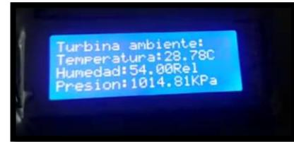
Figura 10. Muestreo de parámetros obtenidos en pantalla LCD de 20x4 ambientales.
