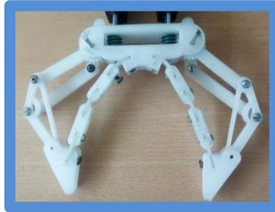
Figura 1.- Diseño del efector final
