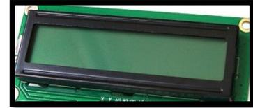
Figura 7. Pantalla LCD 16x2.
