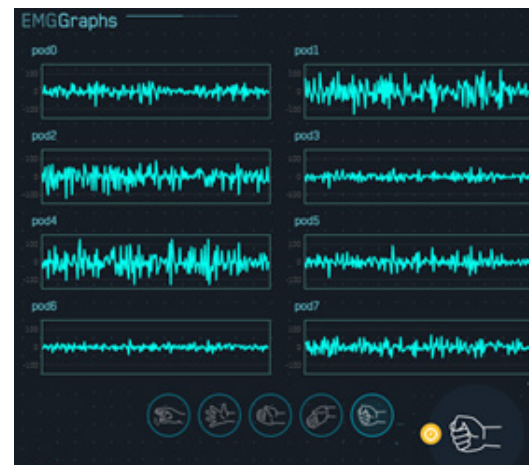
Figura 24. Señales tomadas del puño e indicadores mostrando la acción en prótesis a través de http://diagnostics.myo.com/
