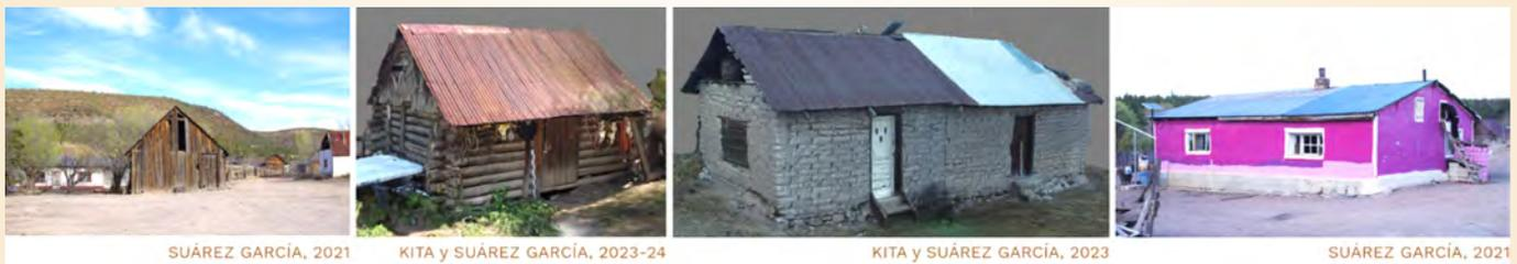
2) の類型は全て、北アメリカから19世紀半ばに西シエラ・マドレ山脈一帯に伝播した、丸太の上部に切り込みを入れて組み合わせるタイプのログハウスです。19世紀後半のモルモン教徒の移住に伴って普及したとも考えられます (図4)。また、現在は空き家1軒の例が残るのみですが、屋根葺き材は、トタン以前は、松の板だったそうです (図5)。
