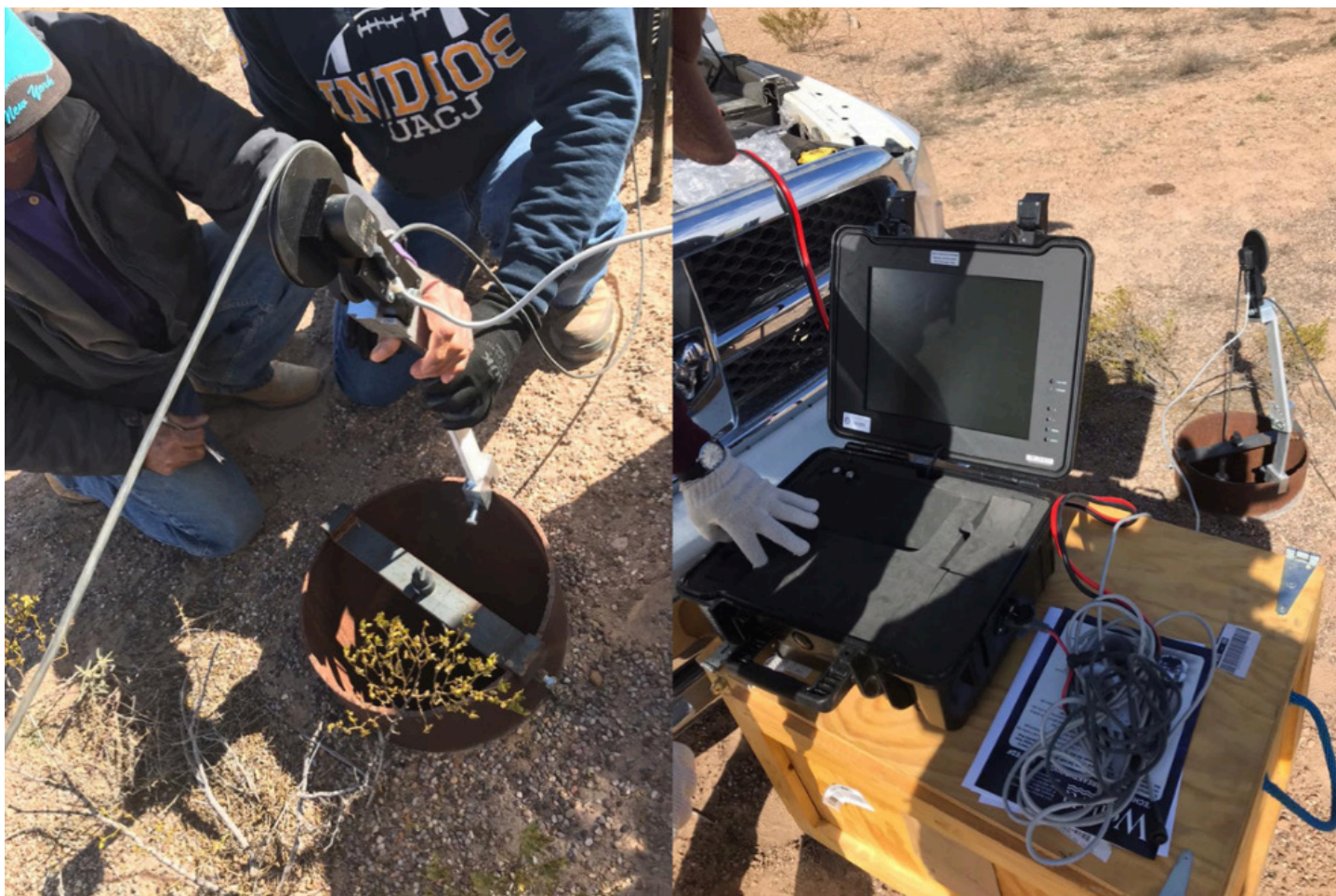
FIGURA 3: Ensamble del soporte metálico en el ademe del pozo y conexión del monitor.
