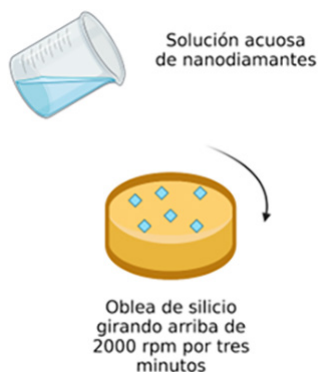
FIGURA 5. Preparación de muestras para evaluación en microscopía electrónica SEM.
