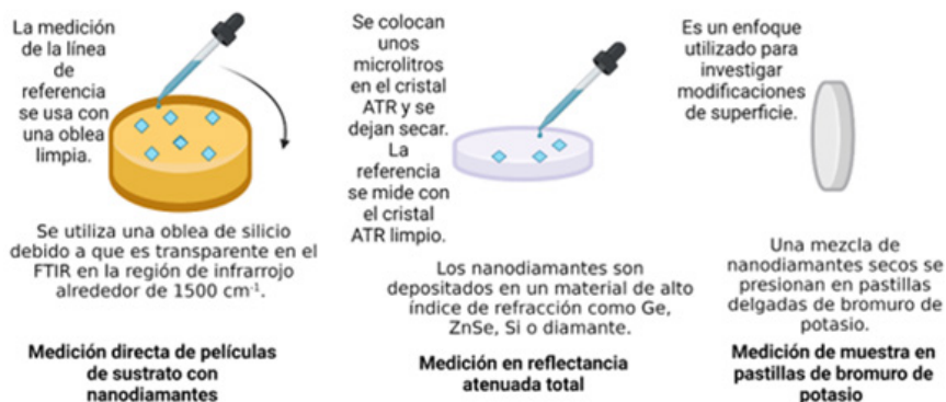
FIGURA 6. Métodos de preparación de muestras utilizados en la caracterización de NDs.
