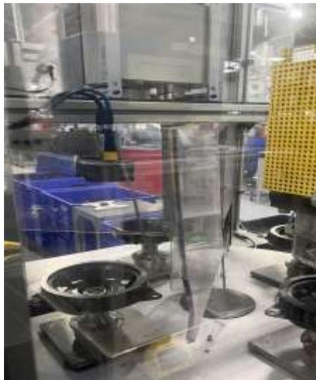
Figura 3. Cámara montada en estación de remachado.
