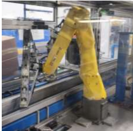
Figura 9. Ejemplo de una posible colisión provocada por un mal análisis del espacio de trabajo.
