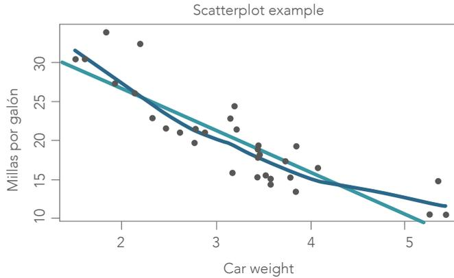
**Figura 16.** Rendimiento del combustible en relación con el peso del vehículo
