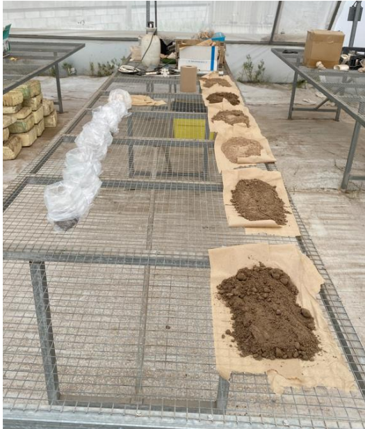
Figura 13. Secado de las muestras de suelo a temperatura ambiente.
