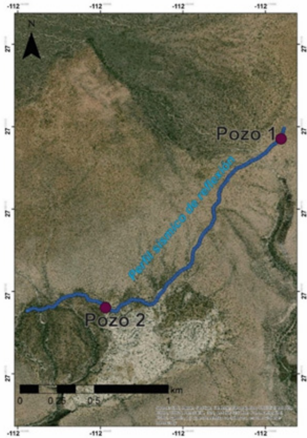
Figura 3. Ubicación del perfil sísmico de reflexión. Los círculos de color azul corresponden a cada uno de los disparos en la adquisición de los datos durante la etapa de campo, utilizando la Fuente sísmica impulsiva (GISCO-ESS500TM). Los círculos color morado corresponden a dos pozos de 55 m de profundidad (Pozo 1 y Pozo 2) los cuales fueron perforados en 2017.
