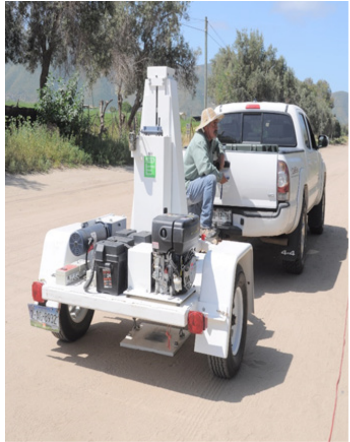
Figura 4. Fuente sísmica impulsiva ESS500-GISCO™ montada sobre un remolque y accionada eléctricamente con marro de 222 kg, misma que fue utilizada en la adquisición de datos sísmicos de reflexión en la caldera La Reforma.
