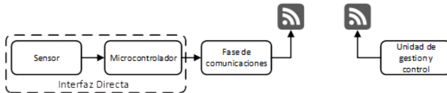
Figura 1 Diagrama de bloques del giroscopio digital inalámbrico.
