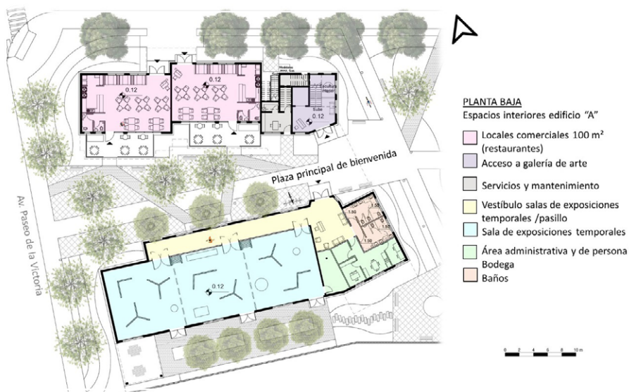
Ilustración 26. Planta baja de Edificio A
