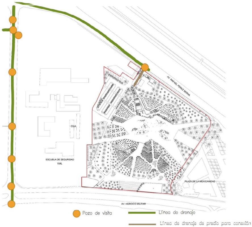
Ilustración 6. Ramal de instalación sanitaria
