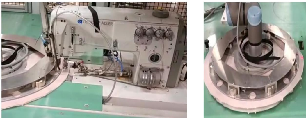
Figura 4. La máquina de coser y la sujeción de la bolsa de aire.
