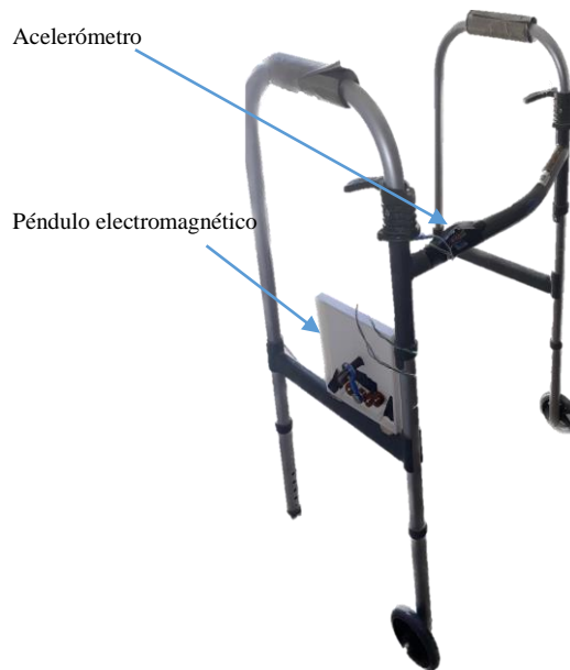
Figura15. Péndulo electromagnético y acelerómetro incorporados en la estructura de un andador para personas mayores.
