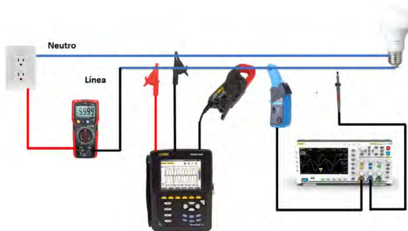
Figura 3. Diagrama de conexiones en banco de prueba para el análisis de calidad de energía de las lámparas LED seleccionadas como objeto de estudio.
