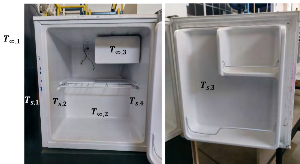
Figura 2. Puntos de medición de temperatura en pruebas experimentales.
