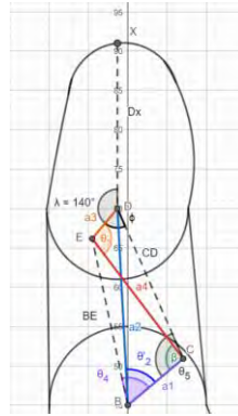
Figura 4. Geometría del mecanismo de la falange medial del dedo robótico.
