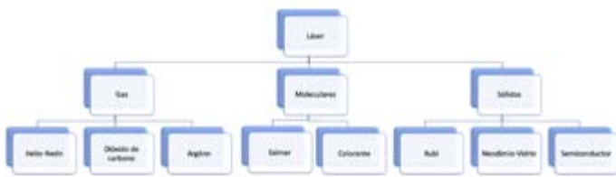
Figura 1. Clasificación general de láser basado en el estado de agregación del cual se hace uso para el láser (Aboites, 2018).
