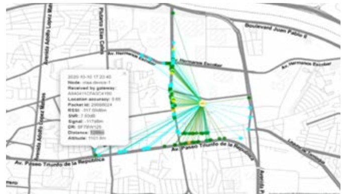
Figura 18. Muestreo de datos ya con integración de base de datos y señalando la distancia máxima.
