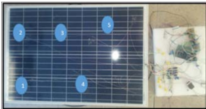
Figura 2. Localización de Sensores Sobre la Celda. Fuente: Elaboración propia.
