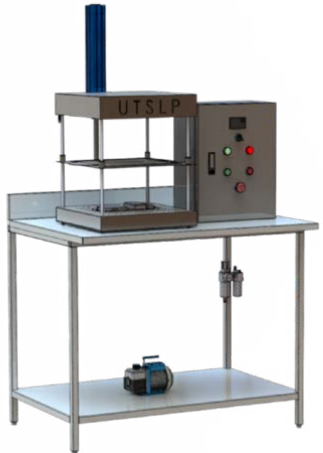
Figura 9. Diseño del sistema de termoformado.
