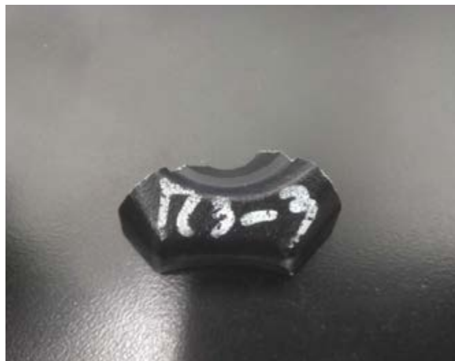
Figura 1. Muestra original de una sección de un rin de aluminio A356. Fuente: Elaboración Propia.
