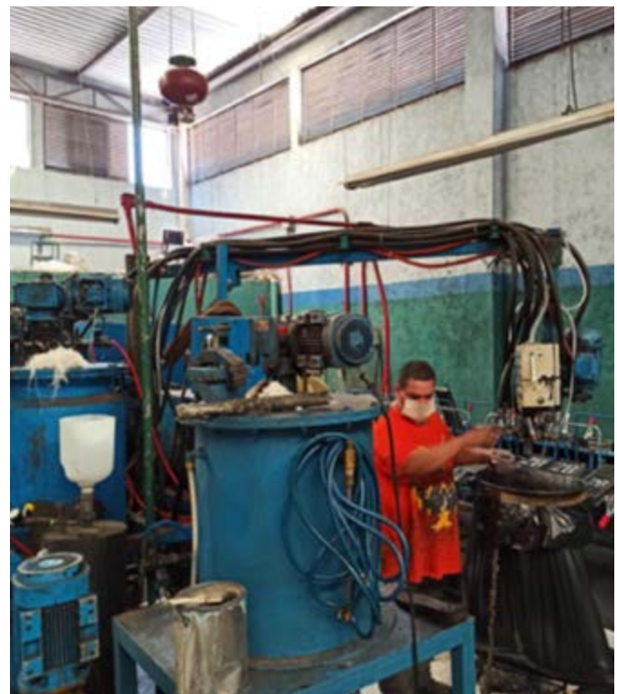
Figura 2. Proceso de fabricación de plantilla de poliuretano por vertido.
