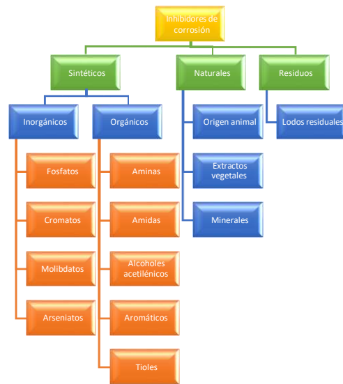
Figura 1. Inhibidores de corrosión clasificados de acuerdo a su origen.
