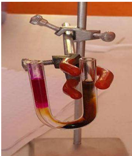
Figura 5. Celda electrolítica con sustancia oxidada y reducida.
