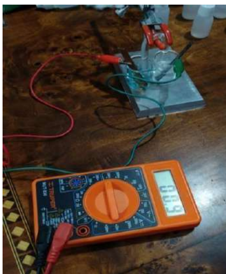
Figura 4. Celda galvánica con resultado de potencial.
