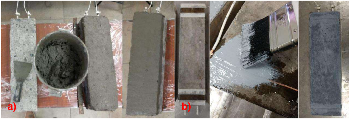
Figura 1. Colocación de sistemas anódicos.
