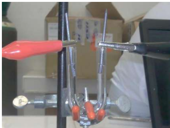
Figura 3. Celda electrolítica a microescala.
