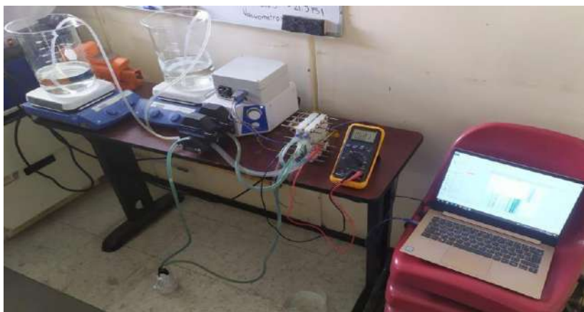
Figura 3. Montaje del módulo de pruebas de electrodiálisis inversa.
