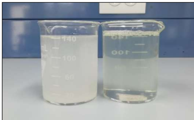
Figura 3. Efluente industrial antes y después del tratamiento
