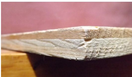
FIGURA 2: ESTRUCTURA POR CAPAS QUE CONFORMAN EL CONTRACHAPADO.
