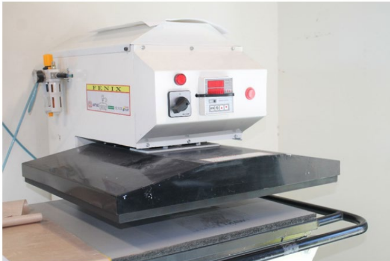
Figura 16 Prensa para sublimación
