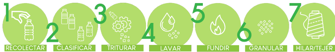
Figura 2 Proceso para obtención de hilo PET
