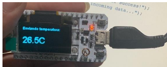
Figura 6. Pantalla OLED de loRa32, donde se muestra la temperatura que está leyendo el sensor.
