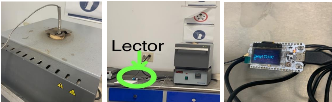
Figura 8 a) Horno de cerámica de la Universidad, b) a su lado izquierdo se encuentra el emisor de temperatura.
