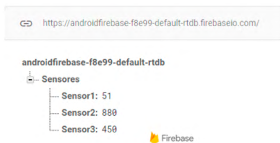
Figura 10. Base de datos Firebase actualizada con la información de los sensores.
