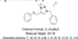
Figura 1. Estructura química de la sal de triazol.
