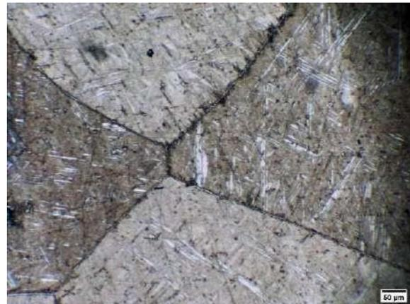
Figura 1. Fase martensítica resultante del enfriamiento rápido de la aleación Cu-9Al-3Ag.
