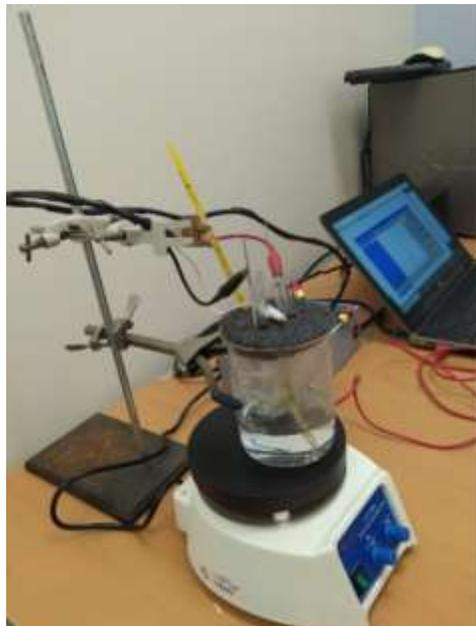
Figura 5.2 Entorno de prueba potenciostato diseñado.
