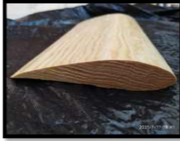
*Ilustración 16 Perfil alar E562 elaborado en madera.*
