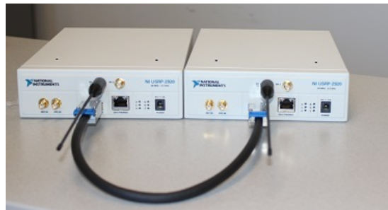
Figura 9 Conexión transmisor a receptor
