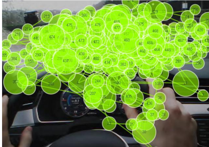
Fig. 1.- Sistema eye-tracker donde se muestra la secuencia y posición de las fijaciones.
