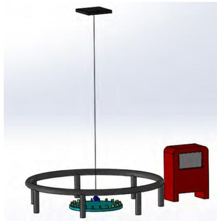
Fig. 6. Algunos diseños preliminares para el *Péndulo de Foucault* propuesto por IADA-UACJ.
