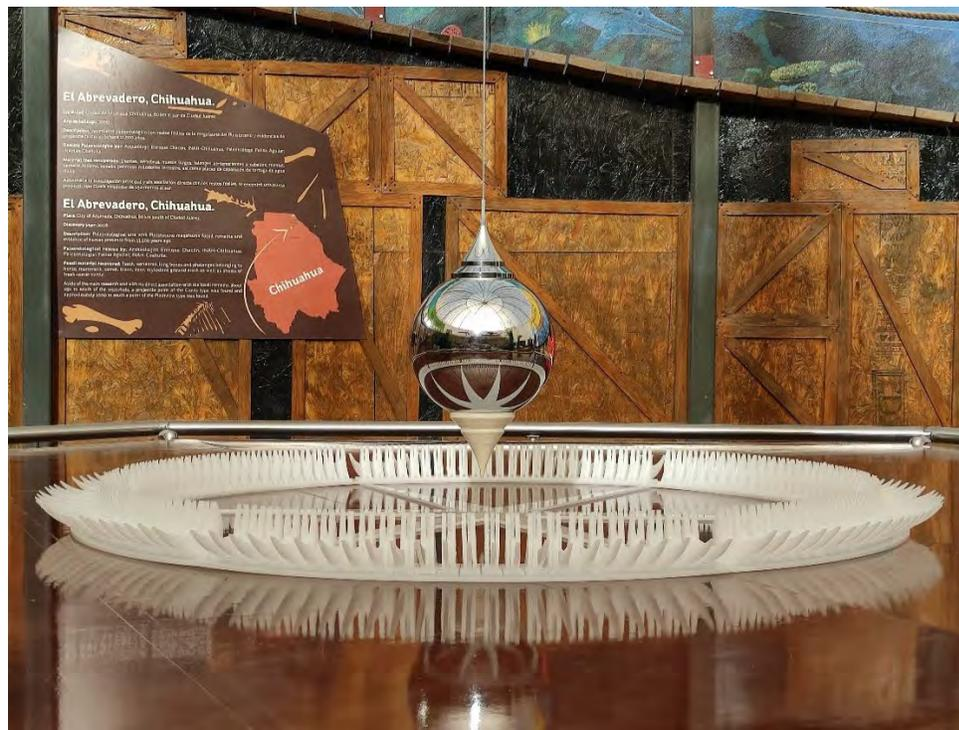
Fig. 2. Vista del *Péndulo de Foucault* junto con testigos tipo “colmillos” que dan evidencia de la rotación de la Tierra.
