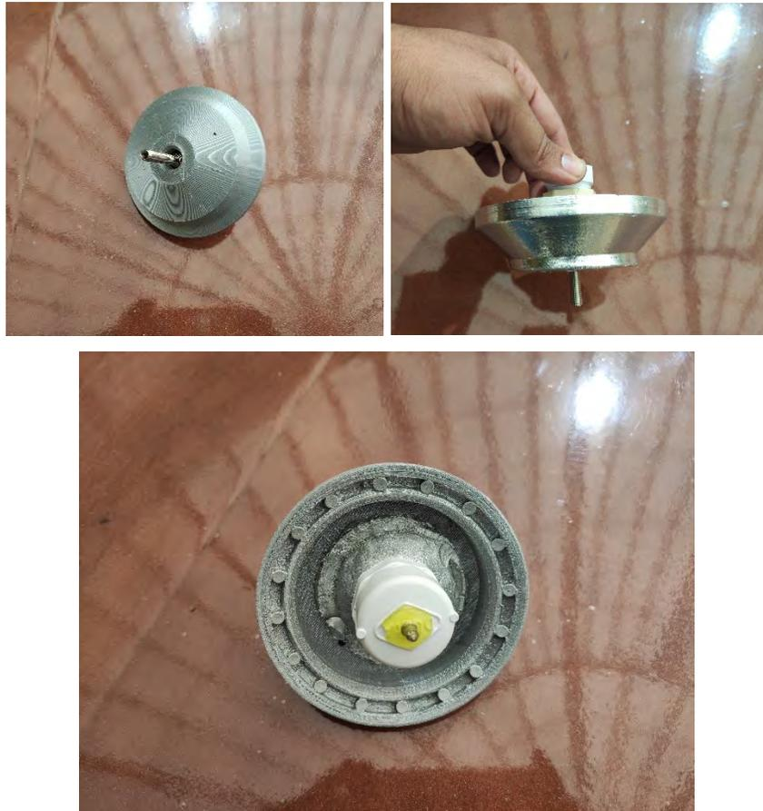
Fig. 28. Dos puntas para el péndulo, el resorte de impacto con los testigos es ajustable en altura, se acoplan magnéticamente a la esfera mediante imanes de neodimio.
