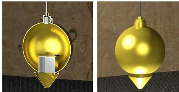
Fig. 5. Detalles técnicos y render preliminar de la esfera de que formará parte del péndulo, exterior de acero A-36 e interior de Plomo.
