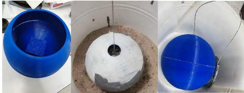
Fig. 7. Elaboración de prototipo de un péndulo a escala 3:1 mediante impresión 3D, plomo y cemento, masa de 12 kg y diámetro de 20 cm.
