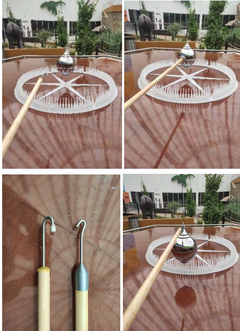
Fig. 27. Bastón de operación del péndulo o bastón de empuje. En un extremo es un gancho para jalar el péndulo y en otro extremo es una pieza recubierta de neopreno para empujar el péndulo.
