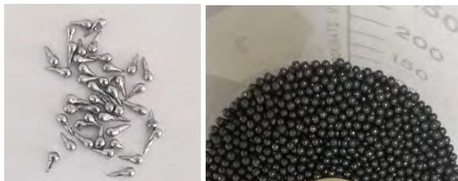
Fig. 10. Plomo interno del péndulo. Se muestra preliminares de fabricación de esferas de Plomo y esferas de 2 mm de diámetro utilizadas.
