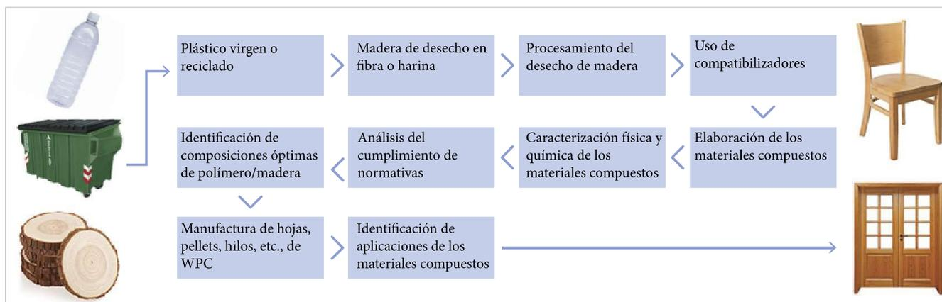
Figura 8. Proceso de fabricación de WPC y la identificación de aplicaciones en diseño de productos.
