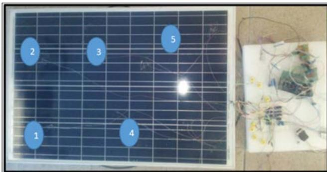
Figura 2. Localización de Sensores Sobre la Celda.
