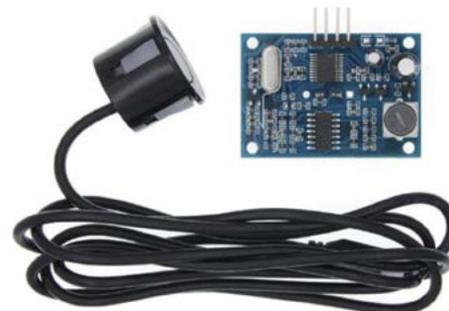
Figura 5. Sensor ultrasónico JSN-SR04T.
