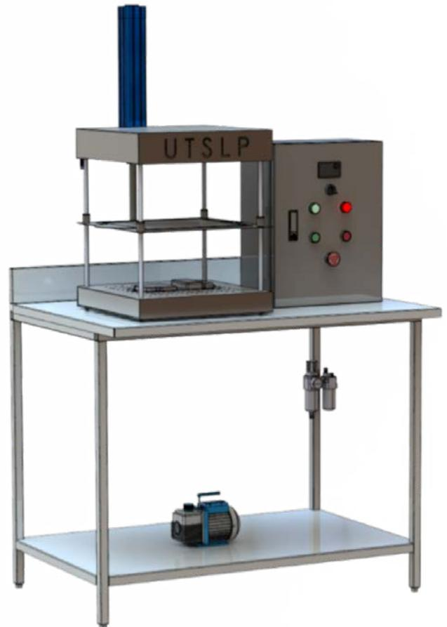
Figura 9. Diseño del sistema de termoformado.
