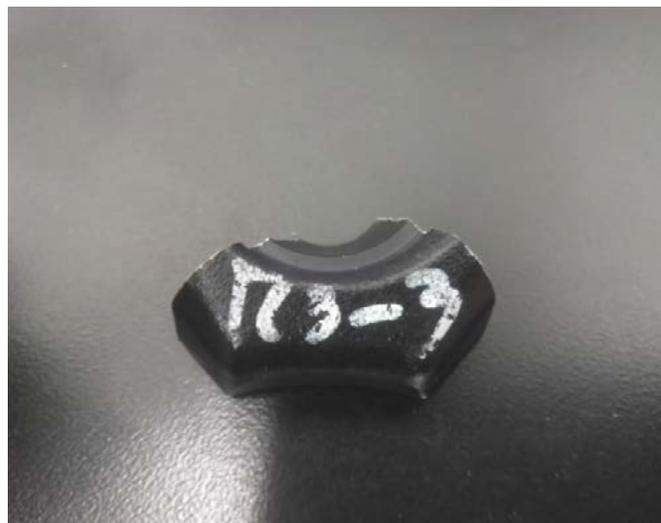
Figura 1. Muestra original de una sección de un rin de aluminio A356.
